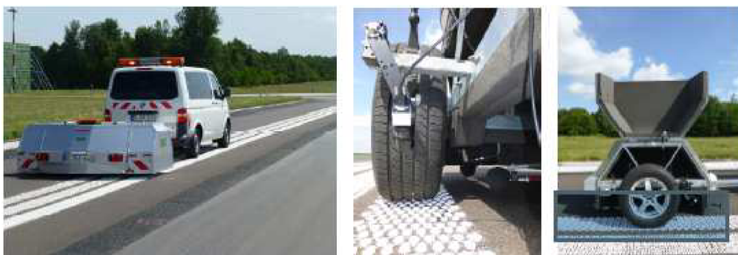
Obrázek 12: Metoda CPX - vozidlo a přívěs [8]
