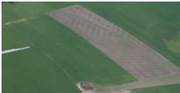
Obr. 4 Letecký snímek se světlými liniemi drenáží, pořízený na půdě bez vegetačního krytu (Tlapáková a kol., 2016)
