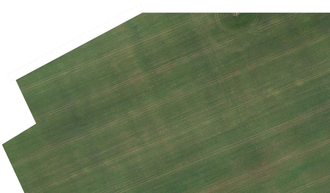
Obr. 19 Tmavé linie vegetace v rýhách předpokládaných drenáží
