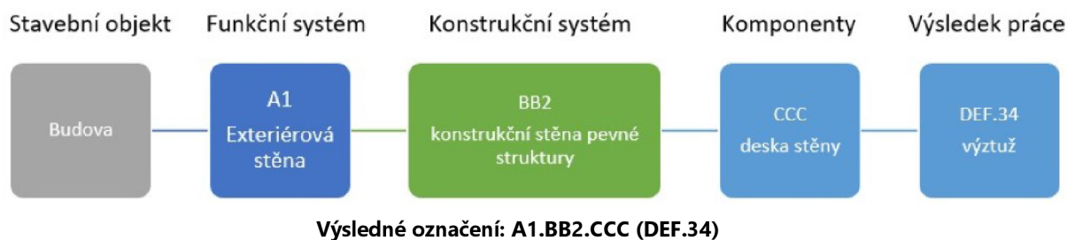
Obr. č. 9: Příklad identifikace prvku modelu pomocí klasifikačního systému CoClass [30]
