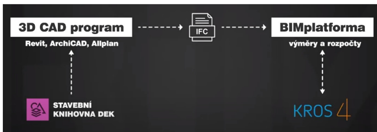
Obr. č. 38: Schéma propojení – BIM PLATFORMA (ÚRS CZ) [89]
