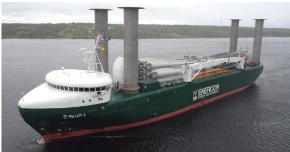
Obr. 2-35 Flettnerovy rotory instalované na palubu nákladní lodi [68]
