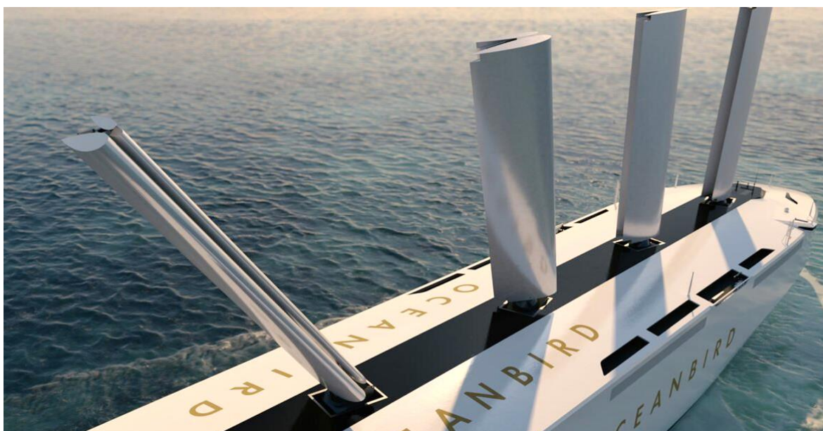
Obr. 2-34 Vizualizace sklápění vertikální křídel Oceanbird Wing 560 [67]
