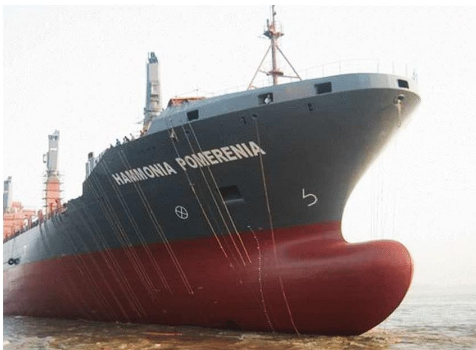
Obr. 2-16 Příď trupu vybavena tzv. bulbous bow konstrukčním prvkem [31]
