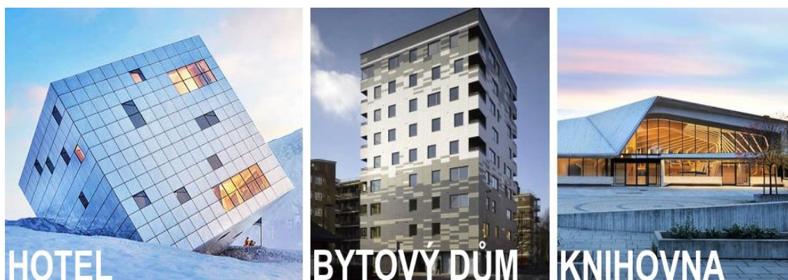
Obr. 48: Stavby z křížově lepeného řeziva CLT: Kežmarská Huť (návrh), Stadthaus, knihovna ve Vennesle 32
