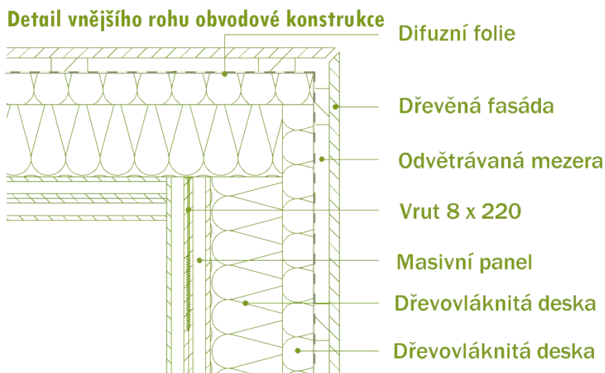
Obr. 66: Detail vnějšího rohu obvodové konstrukce
