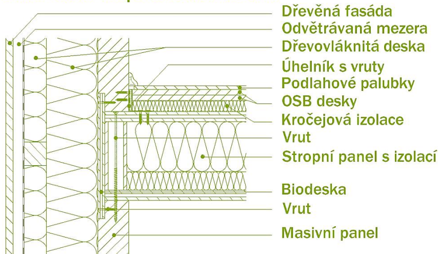
Obr. 68: Detail uložení stropu na obvodovou stěnu
