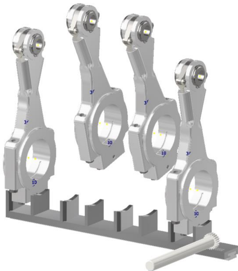
Obr. 28 – Sústava VCR ojníc s mechanickým ovládačom
