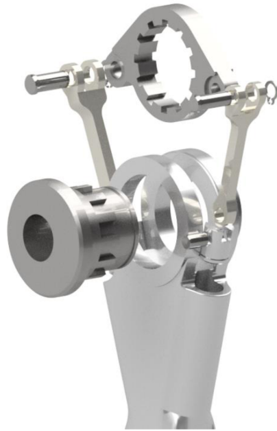
Obr. 26 – Rozložený obrázok vahadlového mechanizmu
