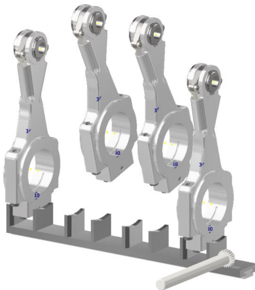
Obr. 28 – Sústava VCR ojníc s mechanickým ovládačom
