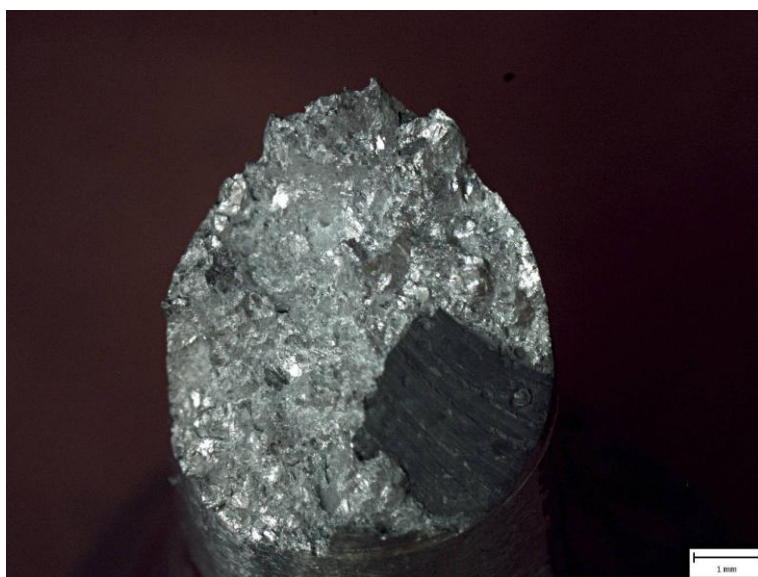
Obr. 20 Oxidická pléna na lomové ploše.
