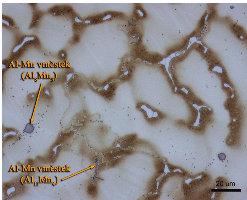
Obr. 22 Slitina AZ61, odlitá metodou Squeeze casting, litý stav, světelná mikroskopie.
