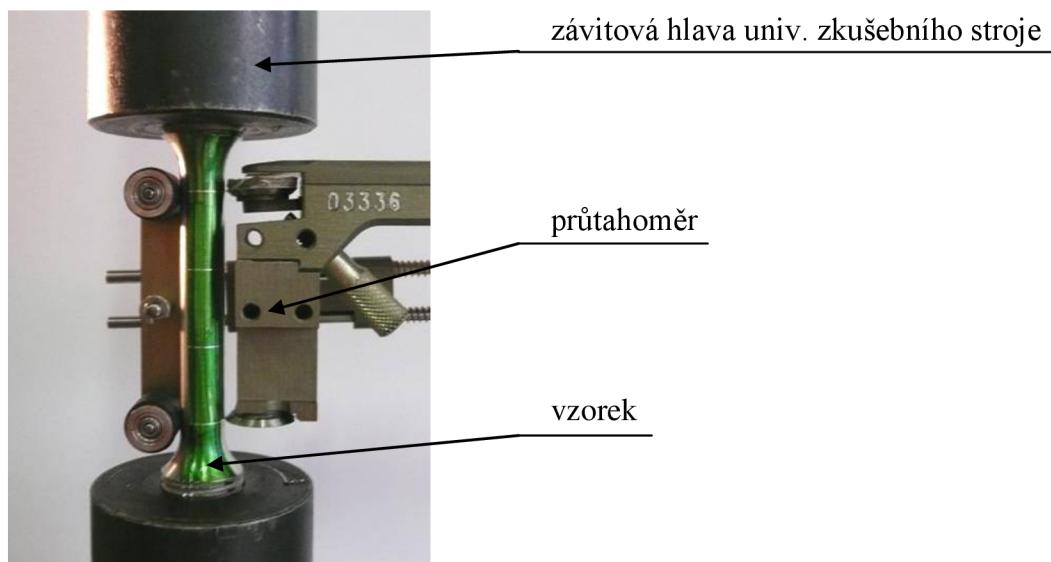
Obr. 15 Uspořádání statické zkoušky tahem.
