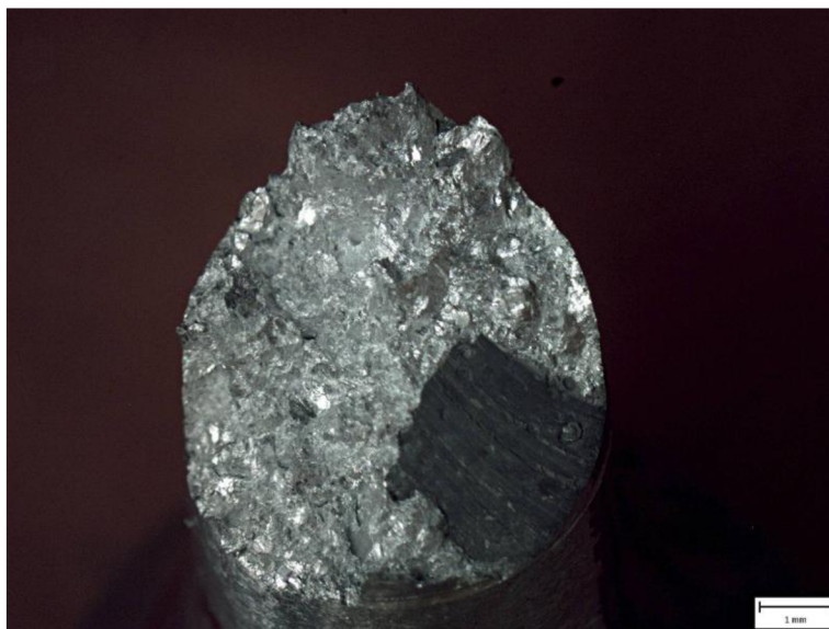
Obr. 20 Oxidická pléna na lomové ploše.
