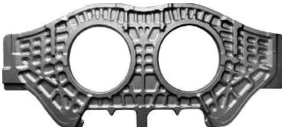
Obr. 14 Výkovek křídlové skříňe stíhacího letounu F-22 Raptor [28]
