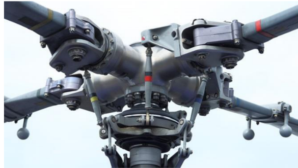
Obr. 18: Rotorová hlava vrtulníku MBB BK 117 [31]
