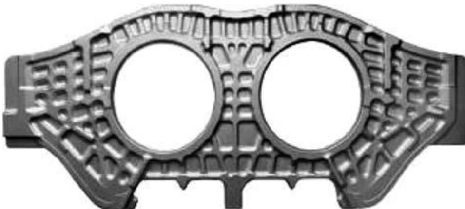
Obr. 14 Výkovek křídlové skříňe stíhacího letounu F-22 Raptor [28]
