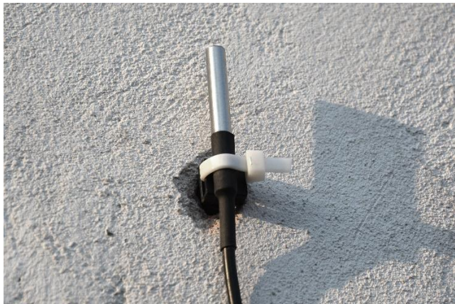
Obr. 6: Zapouzdřený teplotní senzor DS18B20 (zdroj: vlastní fotografie)
