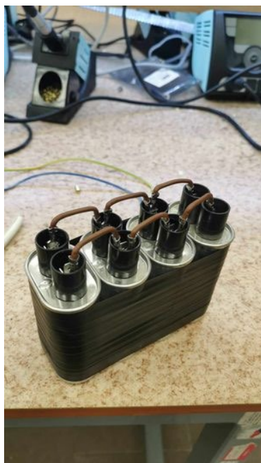
Obr. 28 – Testovací baterie kondenzátorů použitá v usměrňovači
