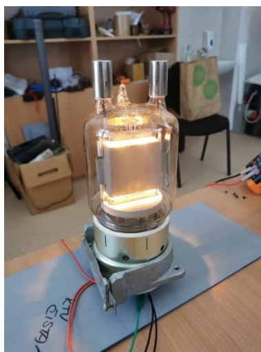
Obr. 24 – GU-81M vsazená v patici při testu žhavení
