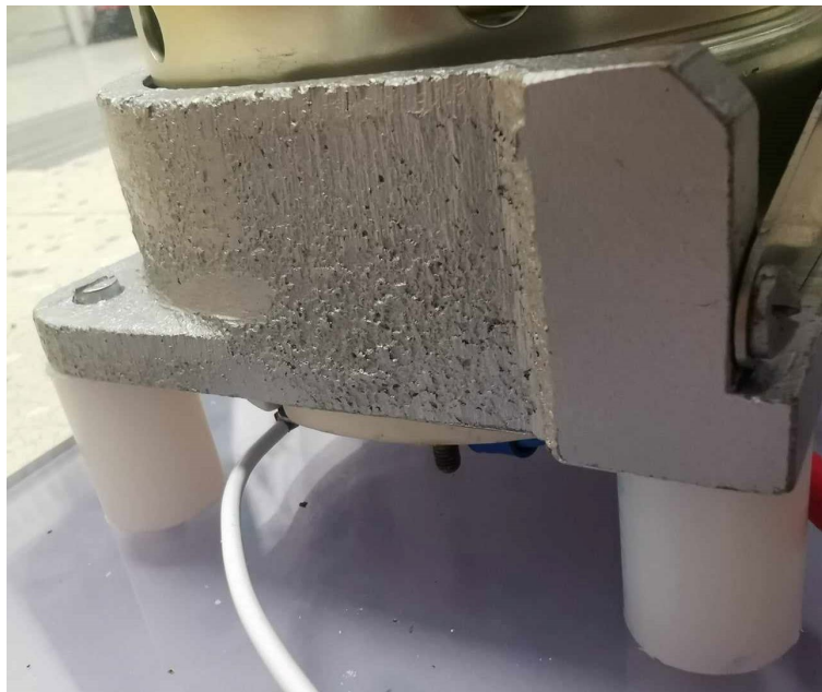
Obr. 45 – Nastavení výšky patice elektroniky plastovými válečky
