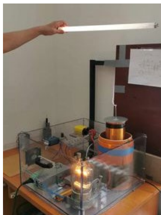
Obr. 53 – Experiment dokazující přítomnost silného elektrického pole
