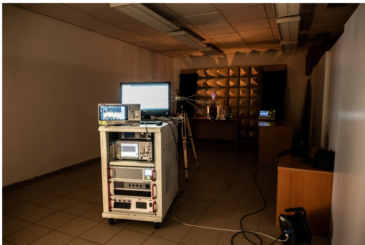
Obr. 50 – Provádění měření vyzařovaného EMI
