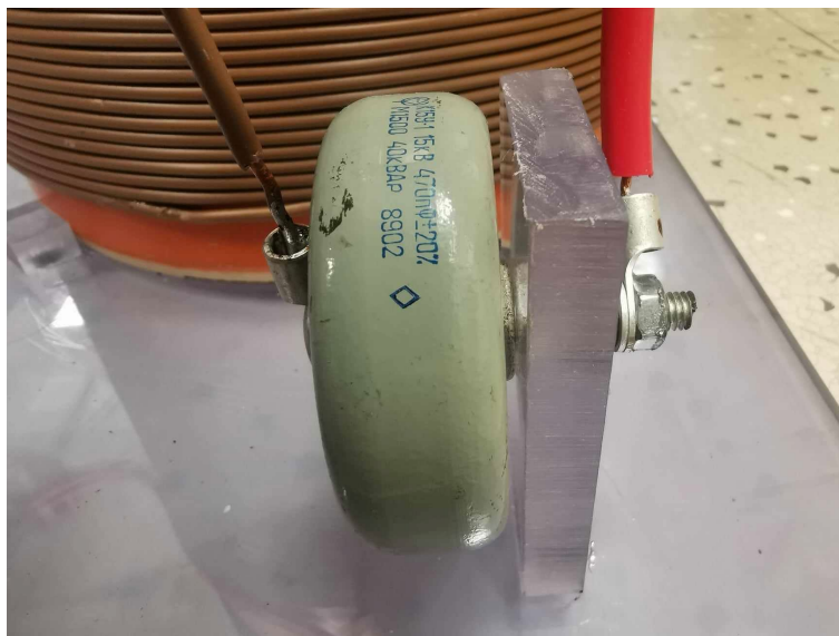
Obr. 47 – Upevnění rezonančního kondenzátoru pro primární vinutí
