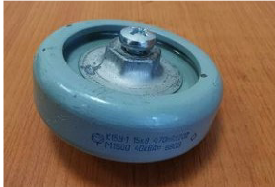
Obr. 33 – Rezonanční kondenzátor pro primární vinutí
