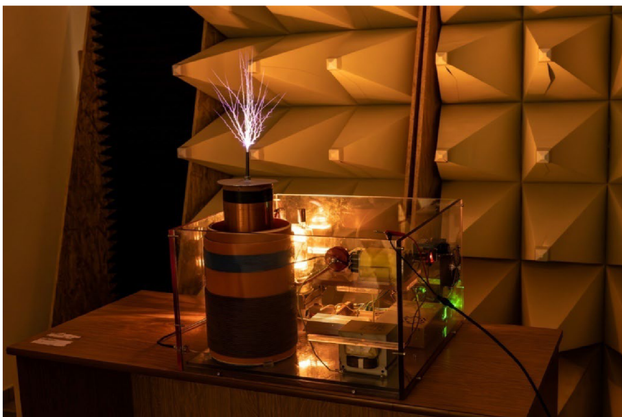
Obr. 54 – Teslův transformátor v provozu
