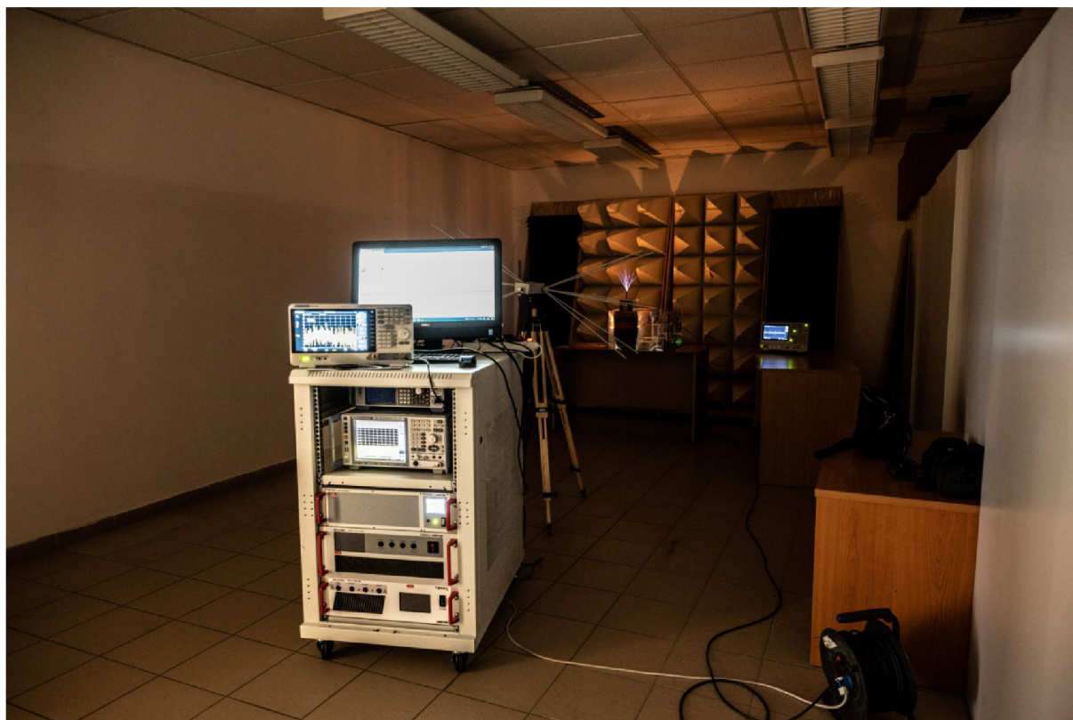
Obr. 50 – Provádění měření vyzařovaného EMI
