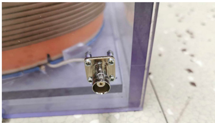
Obr. 42 – BNC konektor pro uzemnění sekundárního vinutí
