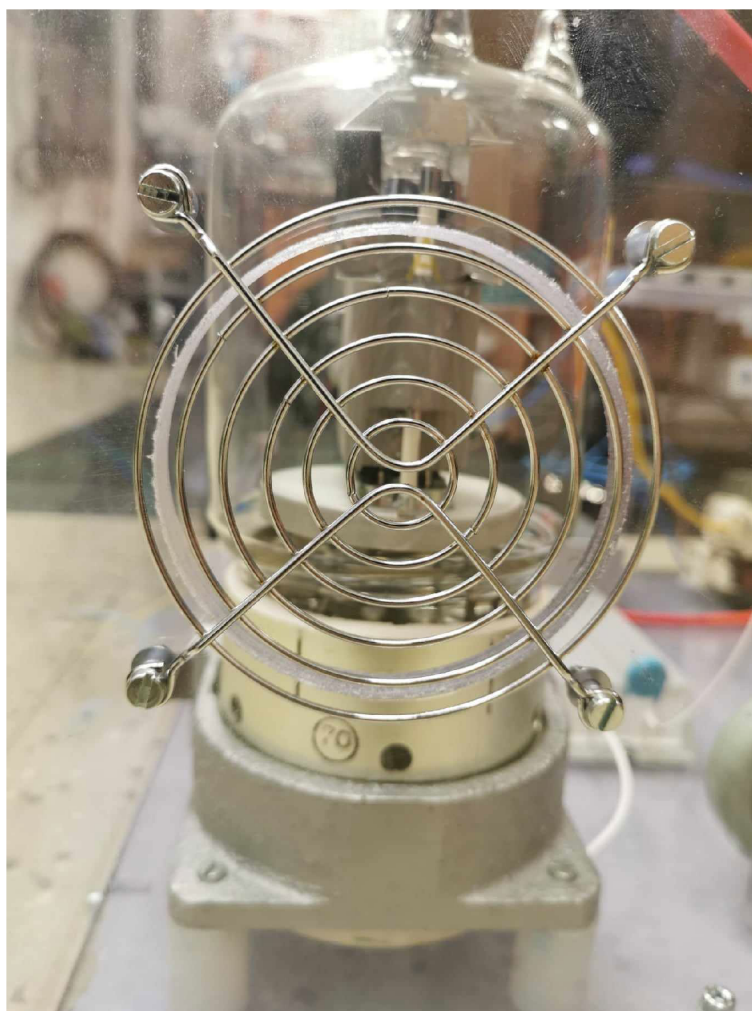
Obr. 44 – Ventilací otvor doplněný ochrannou mříží pro lepší odvod tepla vyzářeného z elektroniky
