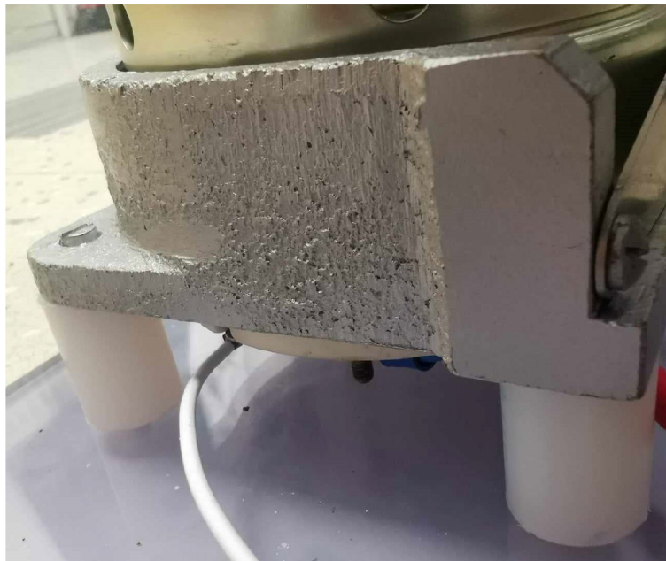
Obr. 45 – Nastavení výšky patice elektroniky plastovými válečky
