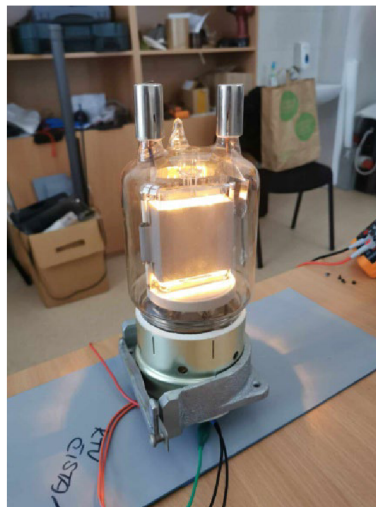
Obr. 24 – GU-81M vsazená v patici při testu žhavení
