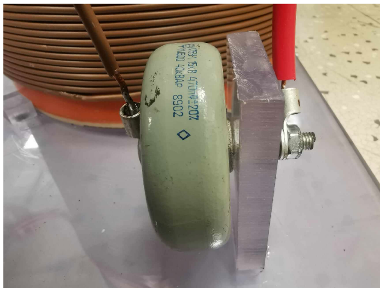
Obr. 47 – Upevnění rezonančního kondenzátoru pro primární vinutí
