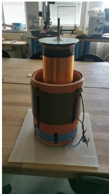
Obr. 29 – Hotová sestava prototypu Teslova transformátoru
