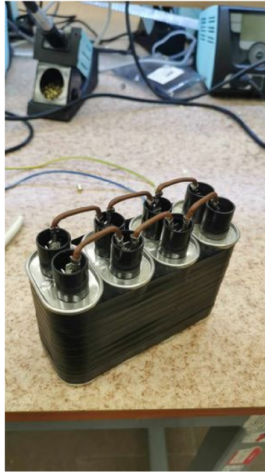
Obr. 28 – Testovací baterie kondenzátorů použitá v usměrňovači
