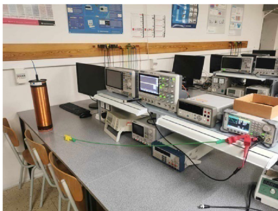
Obr. 32 – Měření rezonanční frekvence samostatného sekundárního vinutí
