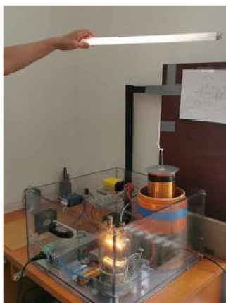
Obr. 53 – Experiment dokazující přítomnost silného elektrického pole
