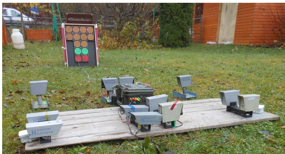
Obrázek 28: Modelové zapojení, z pohledu řidiče. Nejblíže jsou Pre-stage fotobuňky, následují Stage fotobuňky. Poslední jsou startovní fotobuňky. Všechny přijímače jsou uprostřed, propojené s ovládací jednotkou (kufrem). V pozadí rozsvícený semafor.
