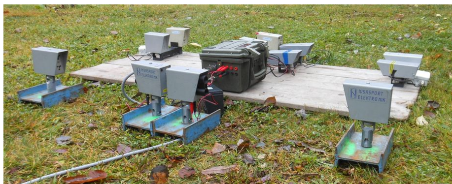
Obrázek 29: Modelové zapojení ze směru od cíle (semafor je za zády). Startovní fotobuňky jsou připojeny k jednotce do pinů, které jsou určeny pro vstup senzorů. Na základě impulsu je generován čas.
