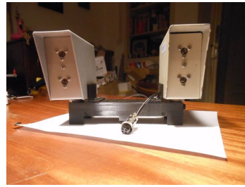
(a) Podstavec pro přijímače fotobuněk (b) Podstavec pod vysílače s novým (starý typ) s laserovým ukazovátkem. pem fotobuněk.
