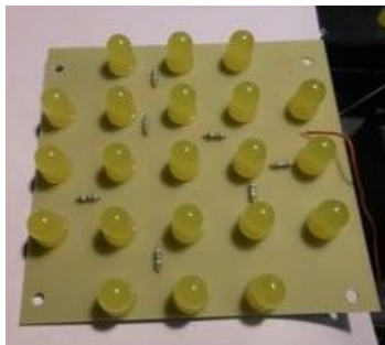
(a) Osazený segment semaforu.
