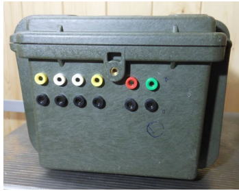
(a) Bok kufru se vstupy od přibližova- rušení, konektorem RM pro ovládání cíh senzorů, vstupem pro spínač a vý- světelných a konektorem pro napájení svě- stupní pin pro externí časovou základnu. tel.
