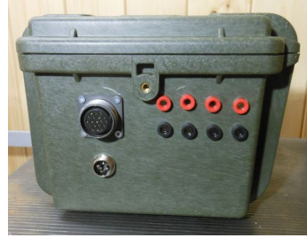
(b) Bok kufru se vstupy pro časové pře- rušení, konektorem RM pro ovládání cíh senzorů, vstupem pro spínač a vý- světelných a konektorem pro napájení svě- stupní pin pro externí časovou základnu. tel.
