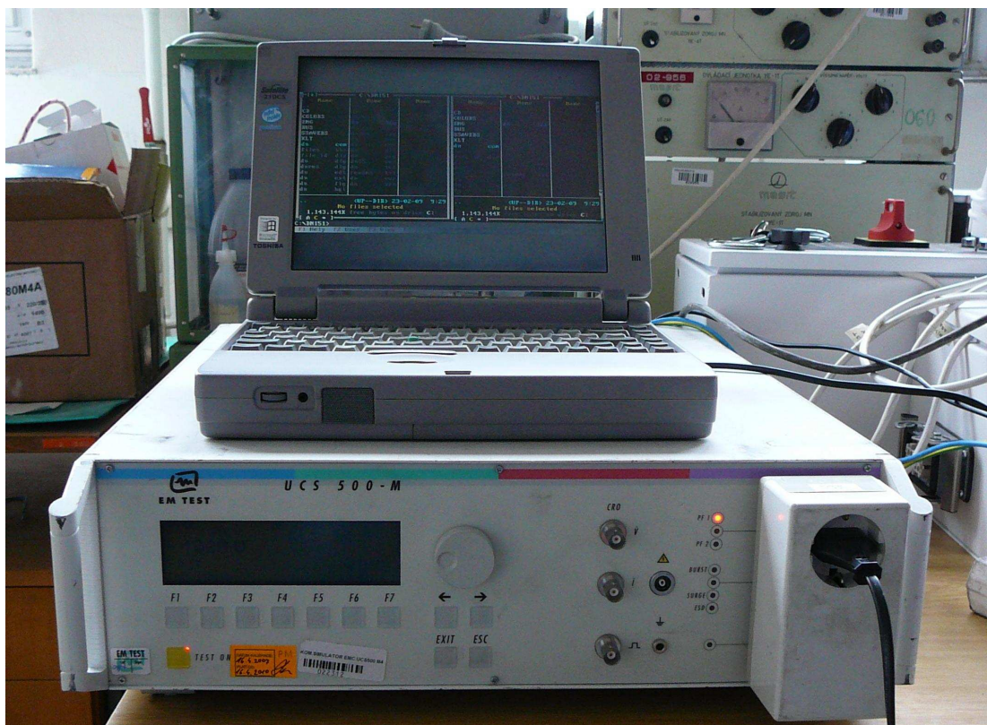
Obr. 16 - Zkouška odolnosti proti skupině rychlých přechodových jevů/skupině impulsů
