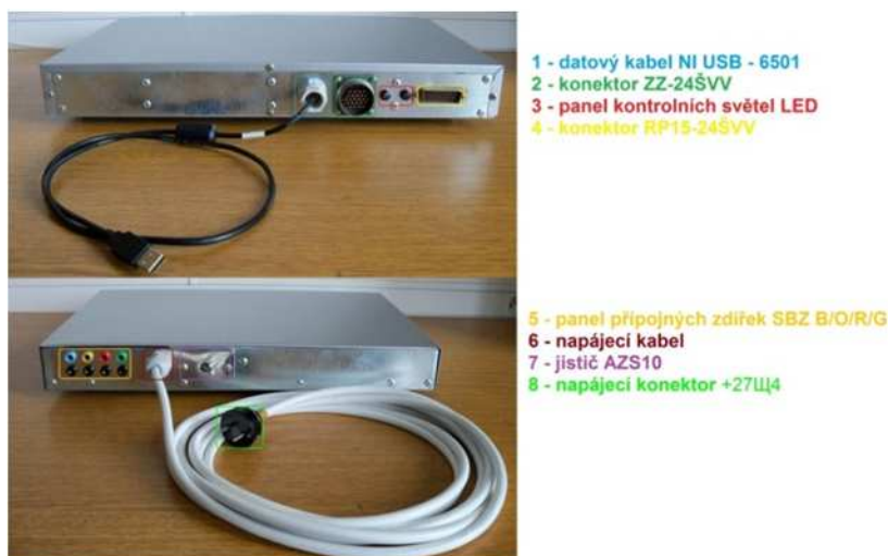
Obrázek 41 Rozmístění prvků digitalizované ovládací skříňky
