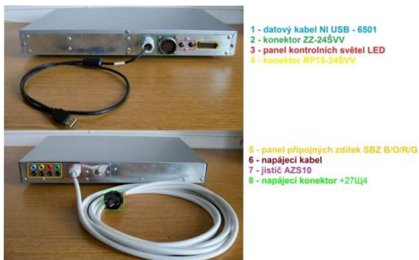
Obrázek 41 Rozmístění prvků digitalizované ovládací skříňky
