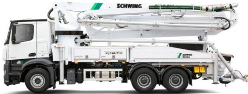
Obr. 38 – Autočerpadlo SCHWING s výložníkem S38 SX REPTOR
