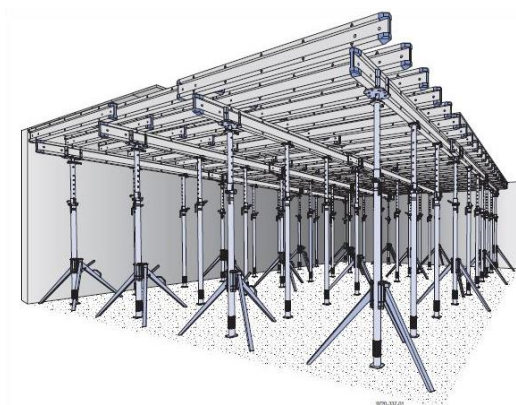
Obr. 68 – Podpěrná konstrukce bednění
