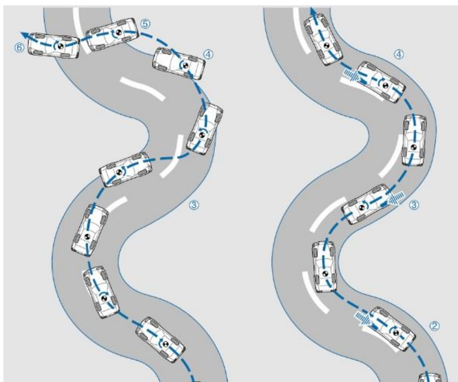
Obr. č. 6 - Rozdíl v jízdě vozidla bez ESP a s ESP [14]
