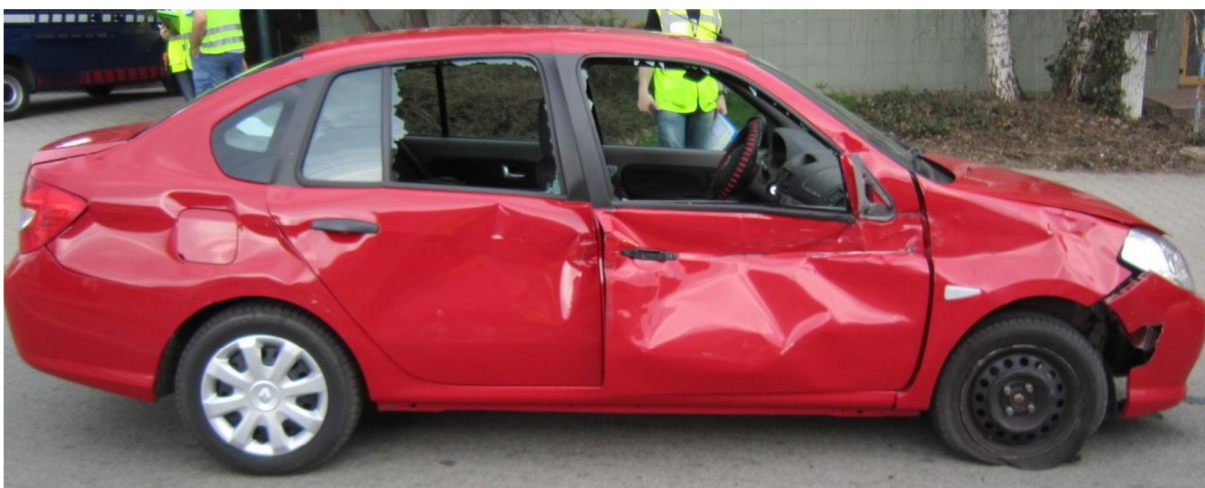
Obr. č. 14 - Poškození vozidla po střetu s kolejovým vozidlem
