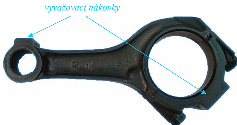
Obr. 2.12 Umístění vyvažovacích nákovků
