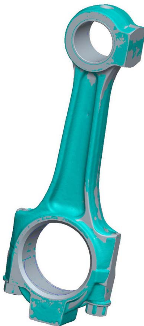
Obr. 4.14 Přiložení scanu a upraveného modelu
