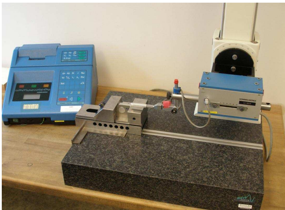
Obr.9.2 Měření drsnosti řezné plochy vzorků
