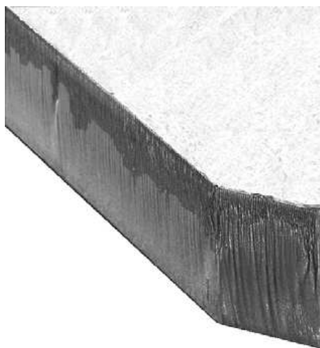
Obr.3.4 Kvalita plochy při řezání laserem s podporou kyslíku [4]
