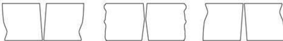
Obr.3.10 Typy řezů při řezání laserem [4]
