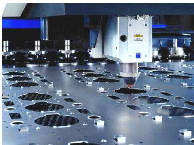
Obr.3.1 Pohled do pracovního prostoru CO 2 laseru [15]
