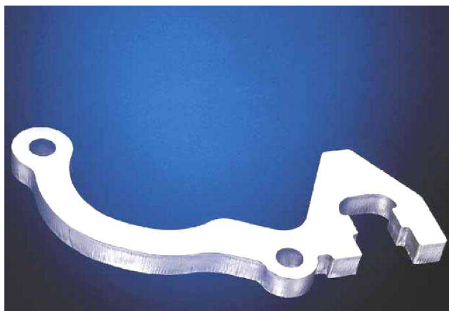
Obr.3.3 Součást vyrobená řezáním laserem s podporou dusíku [4]
