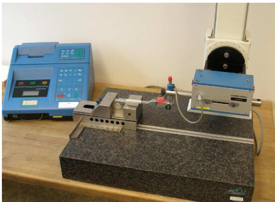
Obr.9.2 Měření drsnosti řezné plochy vzorků
