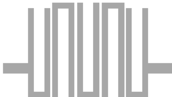
Obr. 14 Motiv mikropáskového filtru odpovídající elektrickému schématu na obr. 12.
