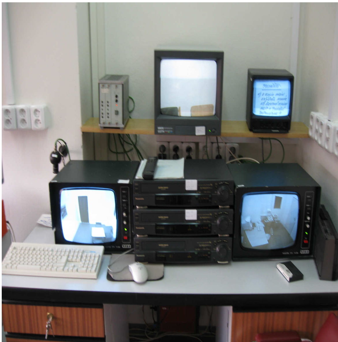
Pohled na komplexní soustavu zařízení potřebných k záznamu obrazu a zvuku ve speciální výslechové místnosti. Komplex sestává ze čtyř monitorů, tří videorekordérů a kamery.
