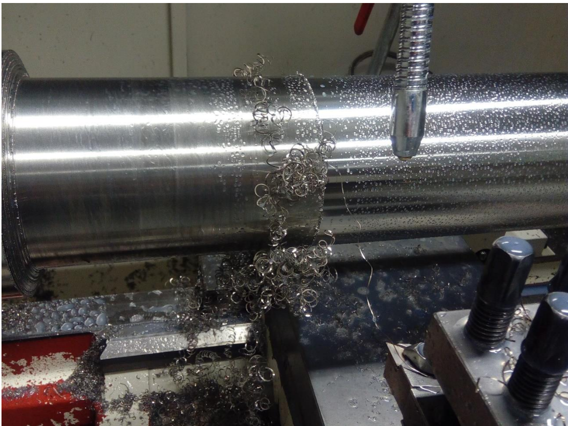
Obr. 41 Odstraňování třísky po jednom intervalu soustružení v délce 50 mm.
