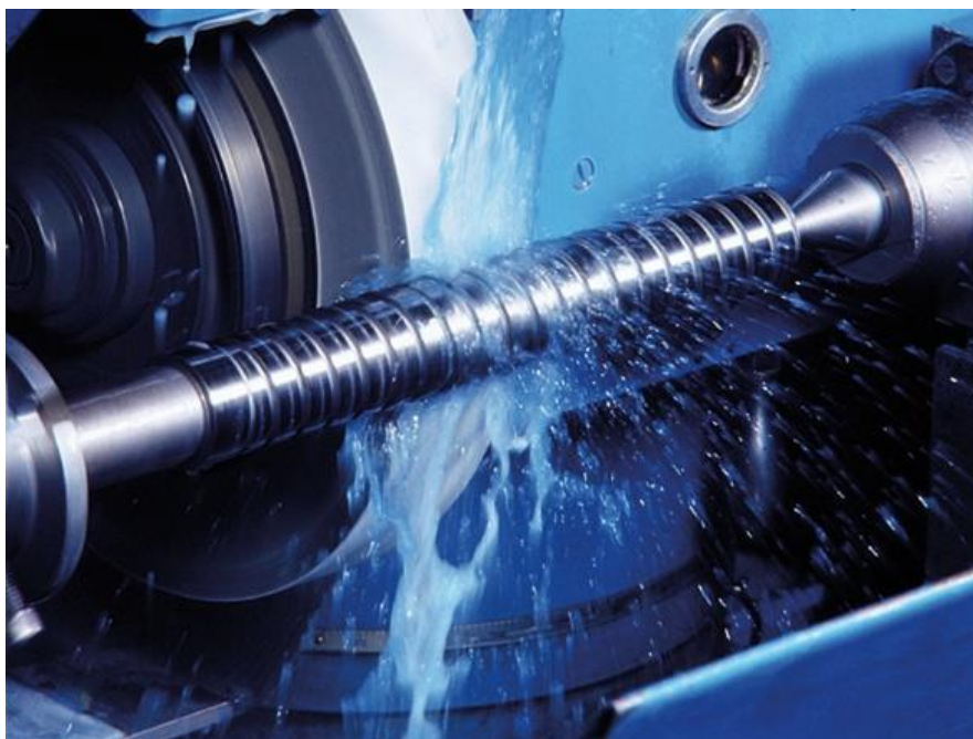
Obr. 7 Syntetická řezná kapalina použitá při broušení [11].
