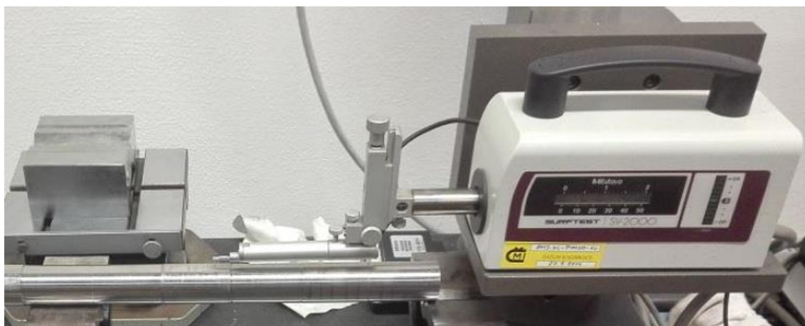
Obr. 44 Laboratorní měřicí přístroj Mitutoyo Surftest 2 000 – SV.
