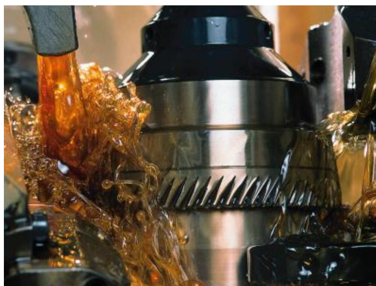
Obr. 6 Chlazení prostřednictvím řezného oleje [10]. Chladicí účinek řezných olejů je výrazně nižší, než v případě vodných roztoků,
