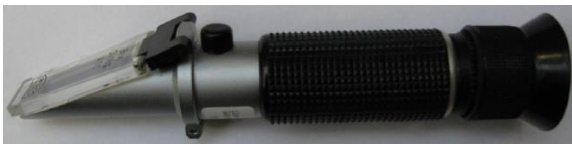
Obr. 39 Refraktometr BRIX 0 – 18% ATC [5].
