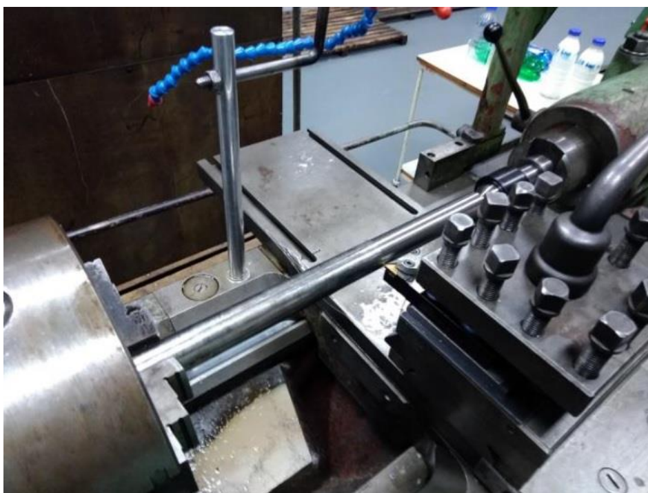
Obr. 42 Soustružení vzorku na hrotovém soustruhu SU 50/1 500.
