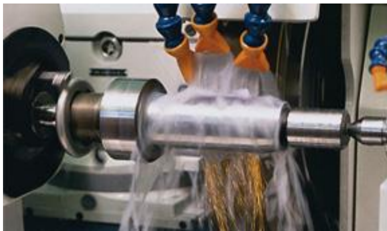
Obr. 8 Chlazení při broušení [13].
