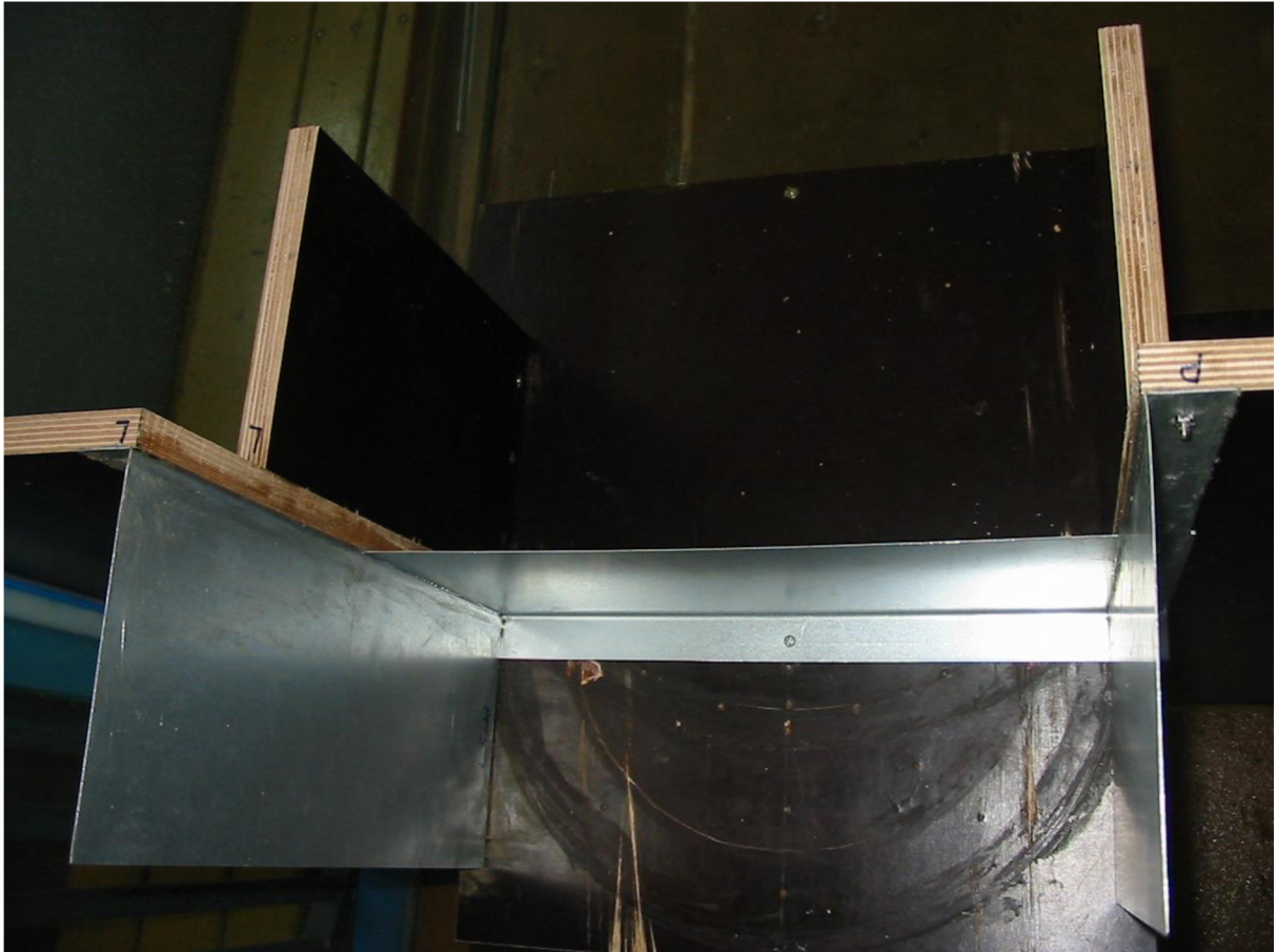
Obr. 4.10 Model přímého přelivu – modelová varianta 7, L/R = 0 , R = \infty mm, pohled shora
