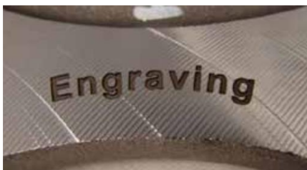
Obrázek 10: Ukázka gravírování do kovového výrobku. Převzato z [13].
