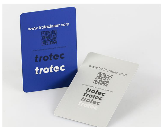
Obrázek 23: Ukázka černého a bílého značení na anodizovaný hliník. Převzato z [24].
