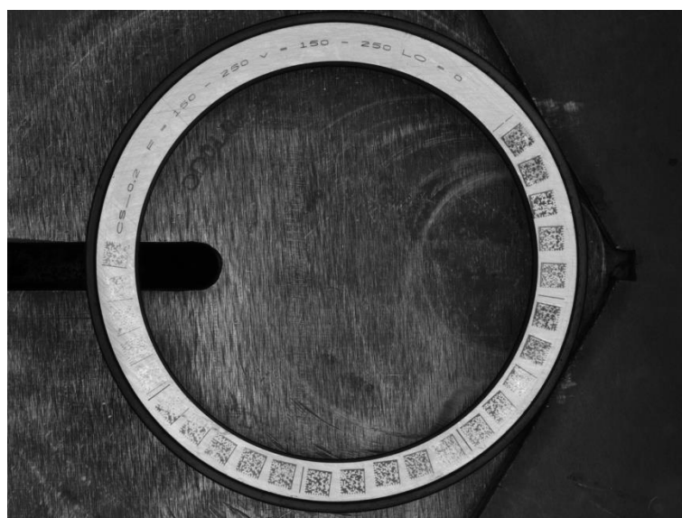
Obrázek 83: Ukázka problému značení na neočištěné ložisko.
