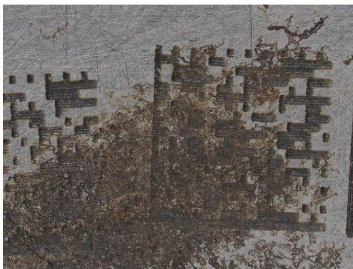
Obrázek 80: Ukázka korodovaného povrchu ložiska.
