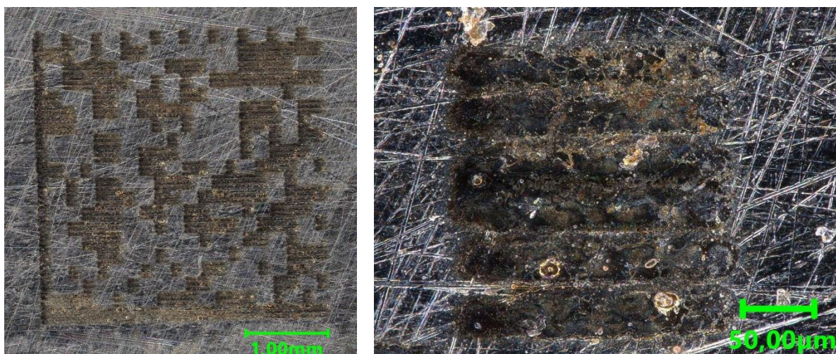
Obrázek 75: a) Ukázka celého kódu a b) detail oxidové vrstvy vyznačené na oceli 1.3505 s parametry značení v = 225 \text{ mm} \cdot \text{s}^{-1} , f = 140 \text{ kHz} , l_{\text{off}} = 0,025 \text{ mm} a P = 20 \text{ W} .
