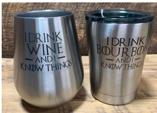
Obrázek 12: Ukázka lokálního leštění povrchu laserem povrchu. Převzato z [16].
