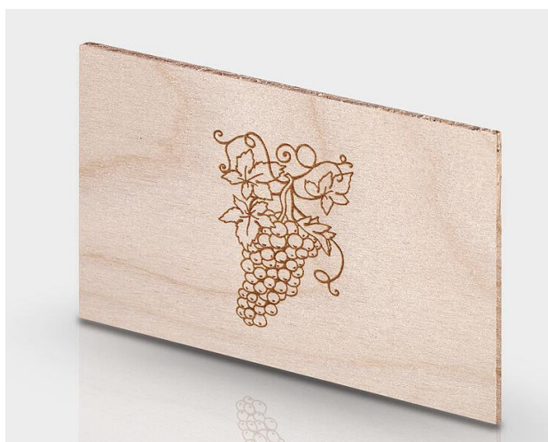
Obrázek 19: Ukázka značení karbonizací na dřevo. Převzatu z [20].
