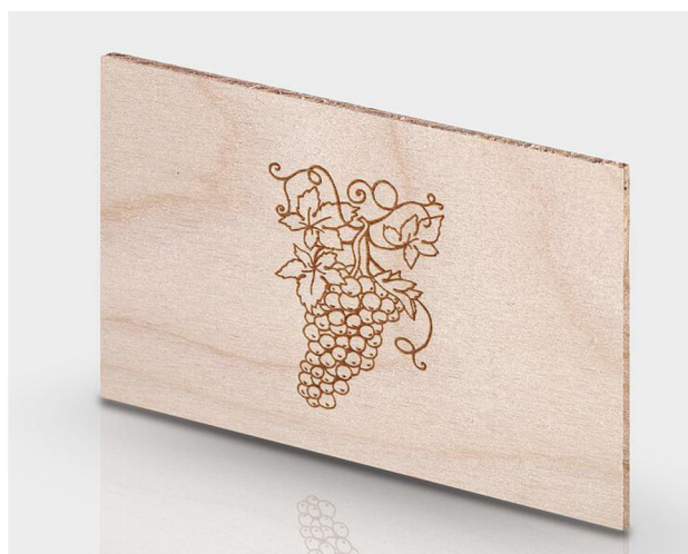
Obrázek 19: Ukázka značení karbonizací na dřevo. Převzatu z [20].
