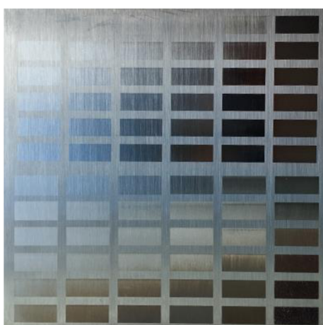
Obrázek 25: Barevné oxidové vrstvy vytvořené žiháním laserem na ocel. Převzato z [26].
