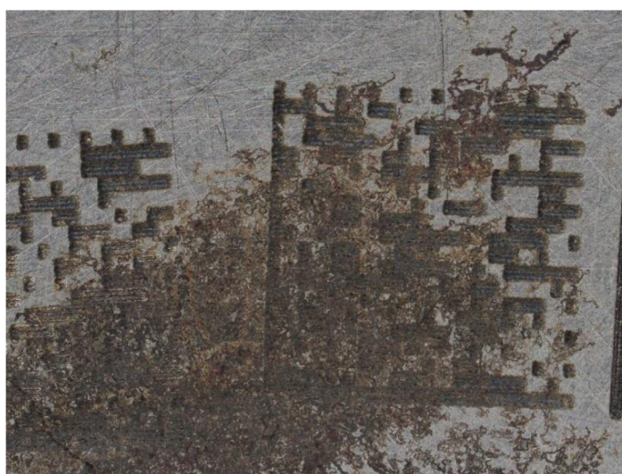
Obrázek 80: Ukázka korodovaného povrchu ložiska.
