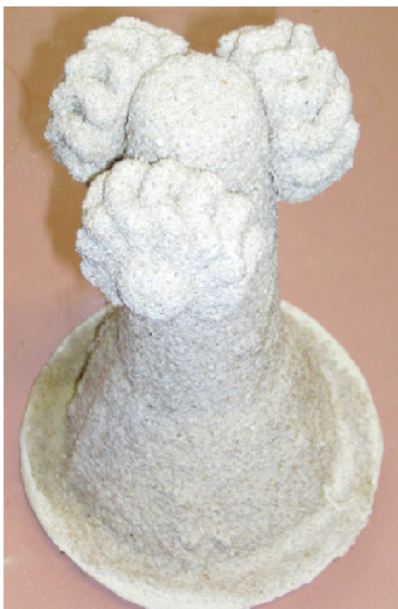
Obr.39: Keramická skořepina se 3 turbínovými koly o \Phi 55 mm
