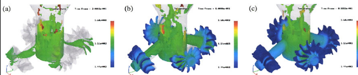
Obr.20: Průběh plnění formy v závislosti na čase a teplotě; a, 15% naplnění (0,3s) b, 30% naplnění (0,6s) c, 50% naplnění (0,99s) při modelování odlévání turbínového kola turbodmychadla pomocí FLOW/3D [12]
