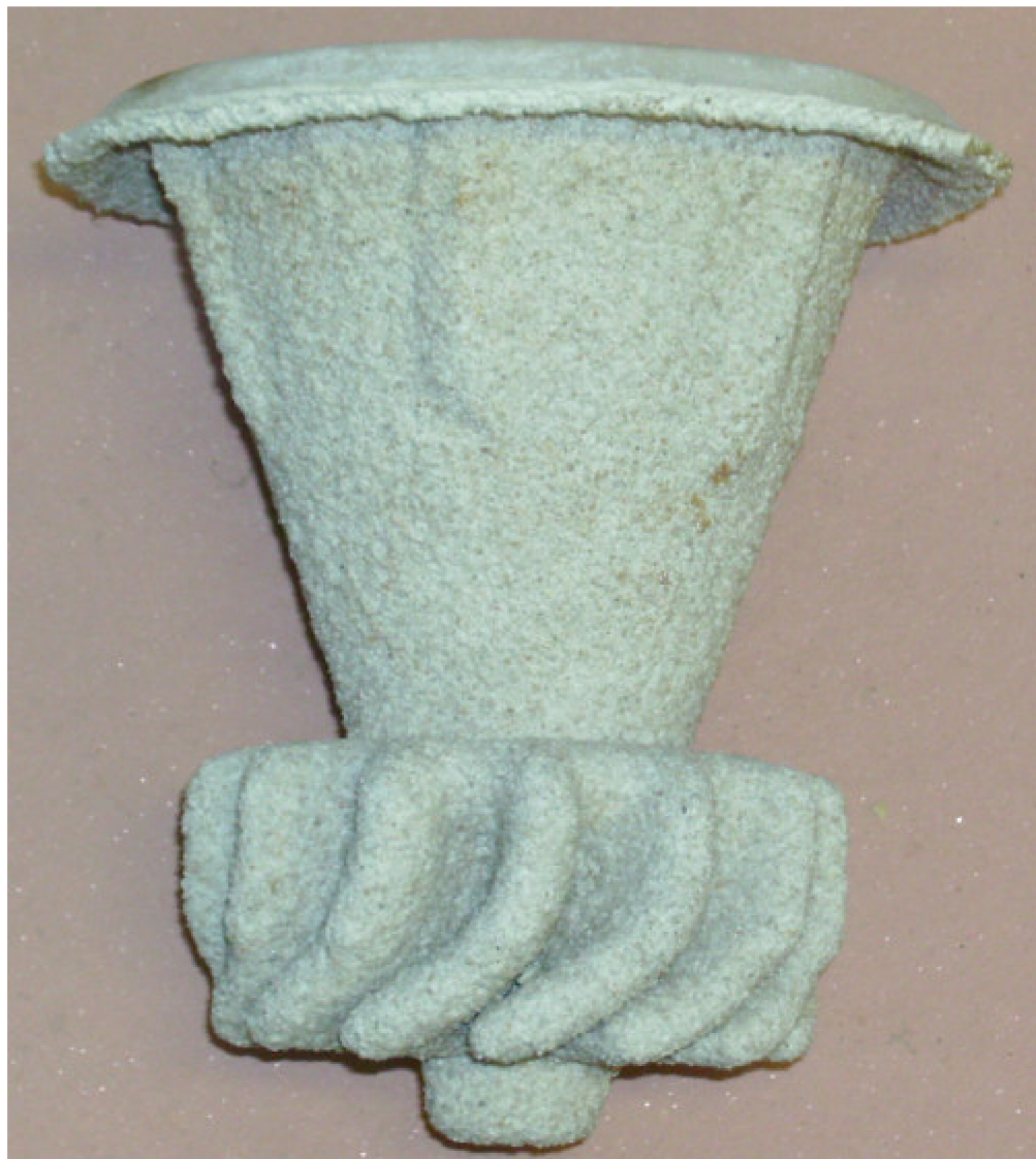
Obr.34: Keramická skořepina turbínového kola o \Phi 115 mm
