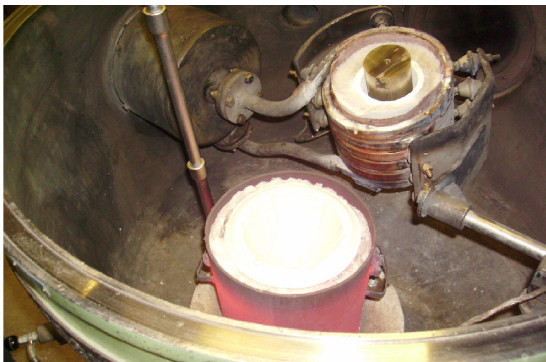
Obr.35: Pohled na uspořádání v peci před tavbou
