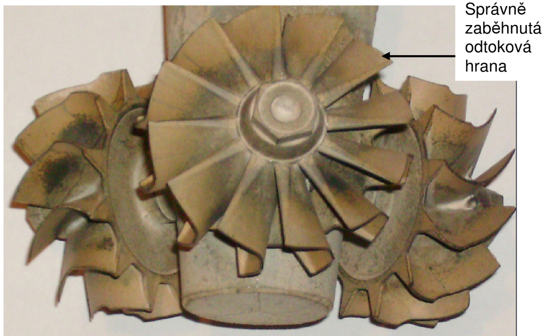
Obr.41: Odlitek oběžného kola \Phi 55 mm litého odstředivě
