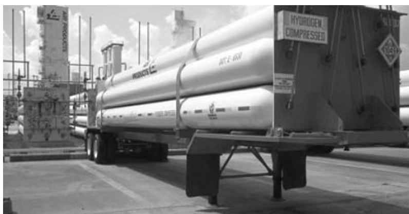
Obr. 6: Bateriové uspořádání nádob na skladování vodíku
