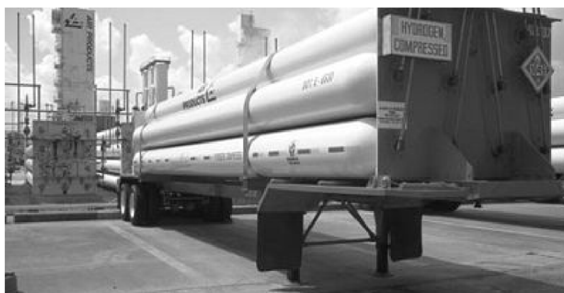
Obr. 6: Bateriové uspořádání nádob na skladování vodíku
