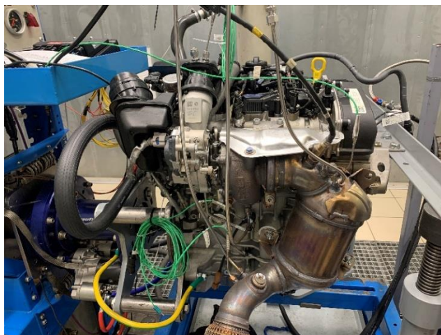
Obr. 5: Testovaný motor na měřicí stoličce osazený měřicími senzory
