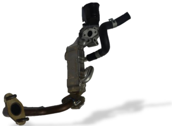
Obr. 1: EGR větev z motoru Honda 1.5 l
