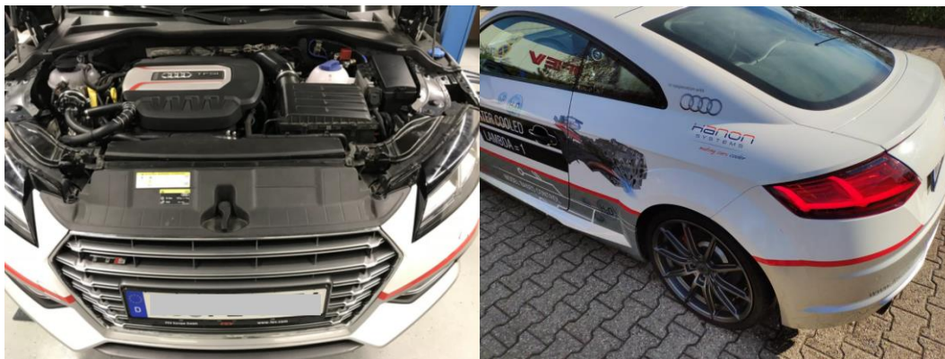
Obr. 19: Experimentální vozidlo s vodním vstřikováním
