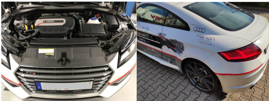
Obr. 19: Experimentální vozidlo s vodním vstřikováním
