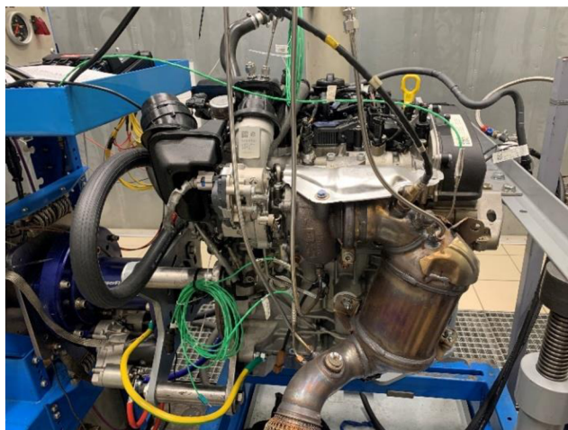
Obr. 5: Testovaný motor na měřicí stoličce osazený měřicími senzory
