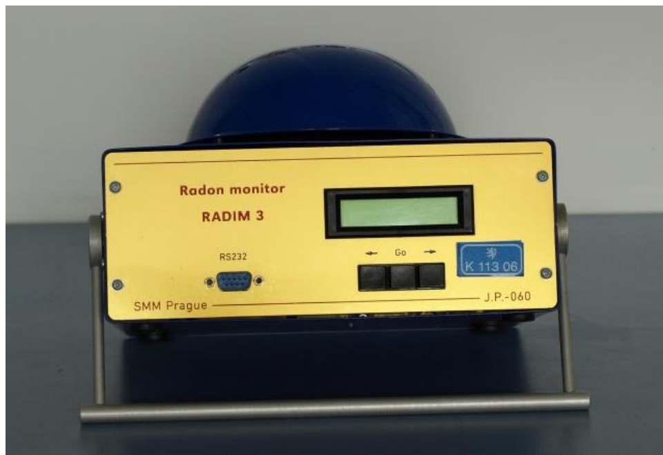
Obr. 10 Kontinuální monitor, Zdroj : https://www.suro.cz/cz/prirodnioz/obecne-informace/mereni-radonu/radim.jpg
