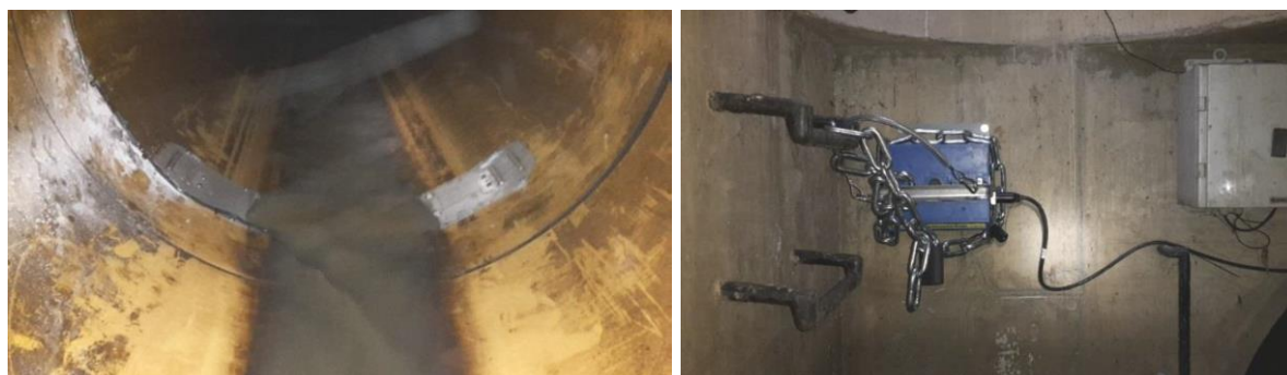
Obr. 4.35 Měrný profil Q4 (vlevo), datalogger ISCO 2150 (vpravo)
