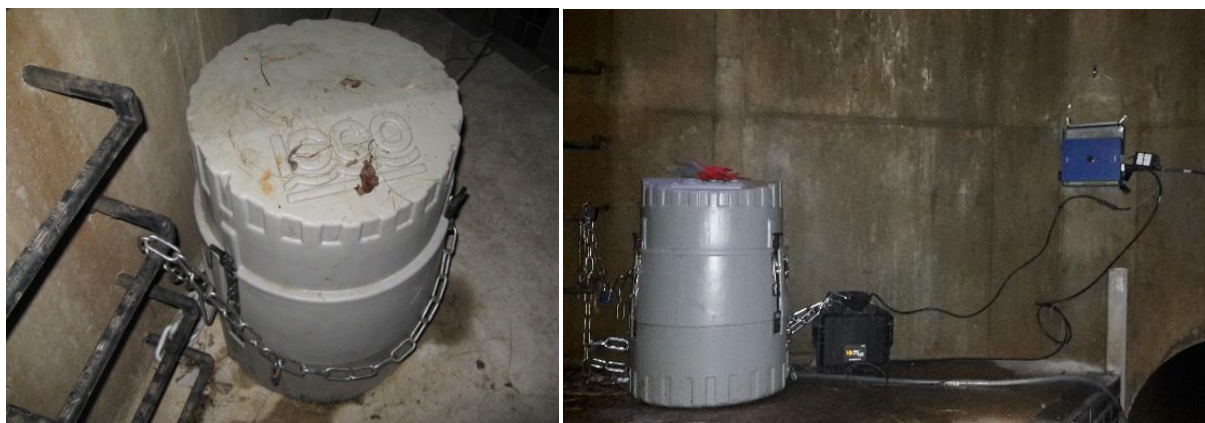
Obr. 4.10 Automatický vzorkovač VZ1 a datalogger ISCO 2150
