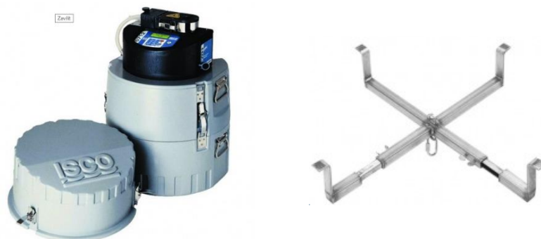
Obr. 3.13 Vzorkovač ISCO 6712 (vlevo), závěsný kříž (vpravo) [16]
