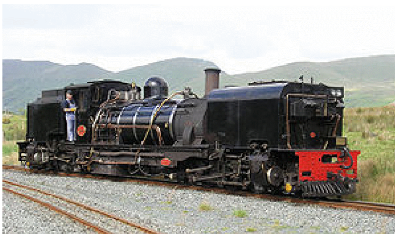
Obrázek č.2: lokomotiva Garratt v Jihoafrické republice na rozchodu 610 mm
