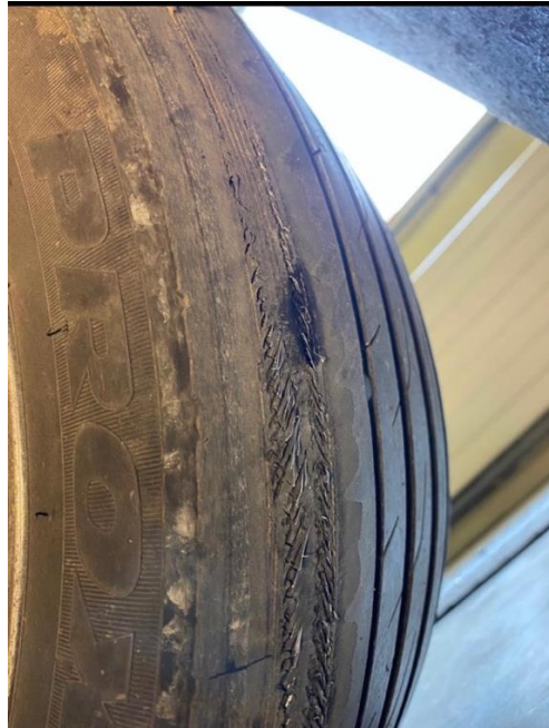
Obrázek 36 - Poškození pneumatiky (Nadměrné opotřebení)[9]
