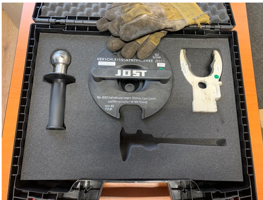
Obrázek 11 - Zařízení na měření průměru spojovacího zařízení [9]
