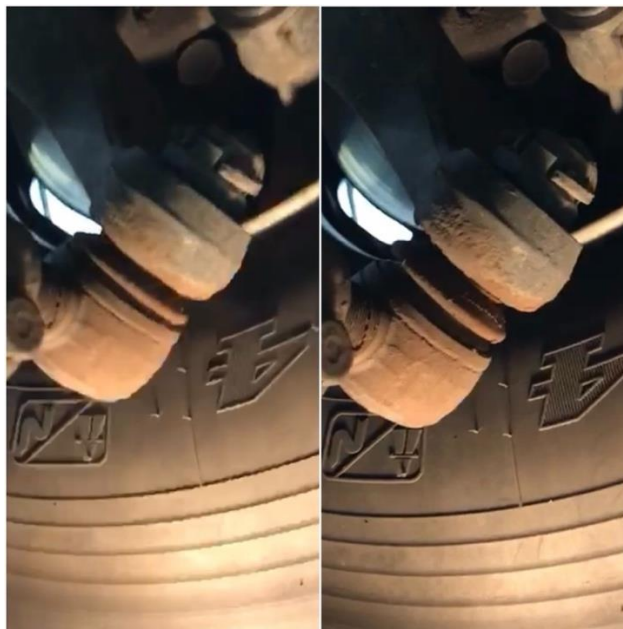
Obrázek 35 – Poškozený čep řízení [9]
