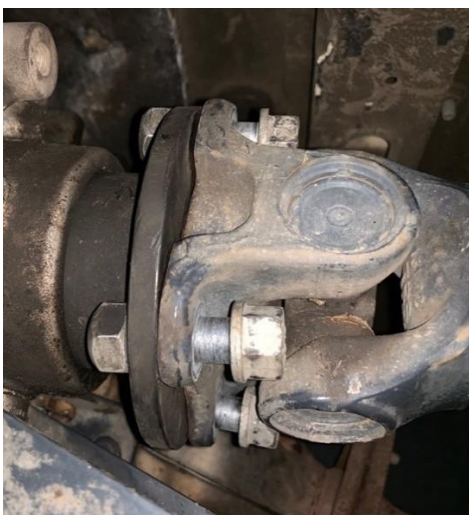
Obrázek 38 - Dotažení šroubů na kardanu [9]
