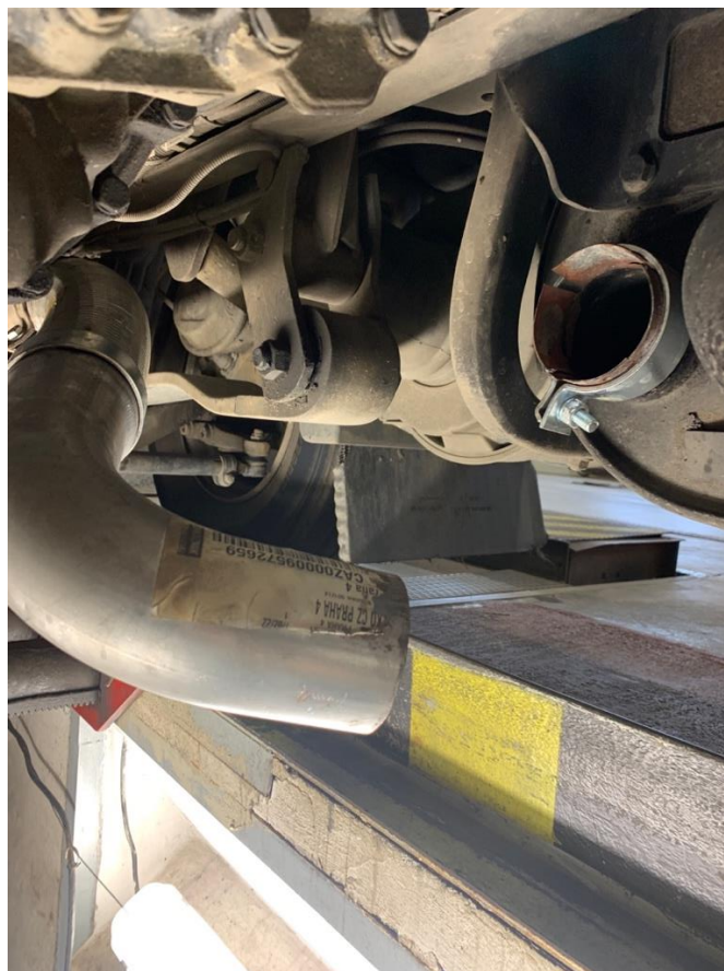
Obrázek 42 - Nedbalost opravy výfuku [9]
