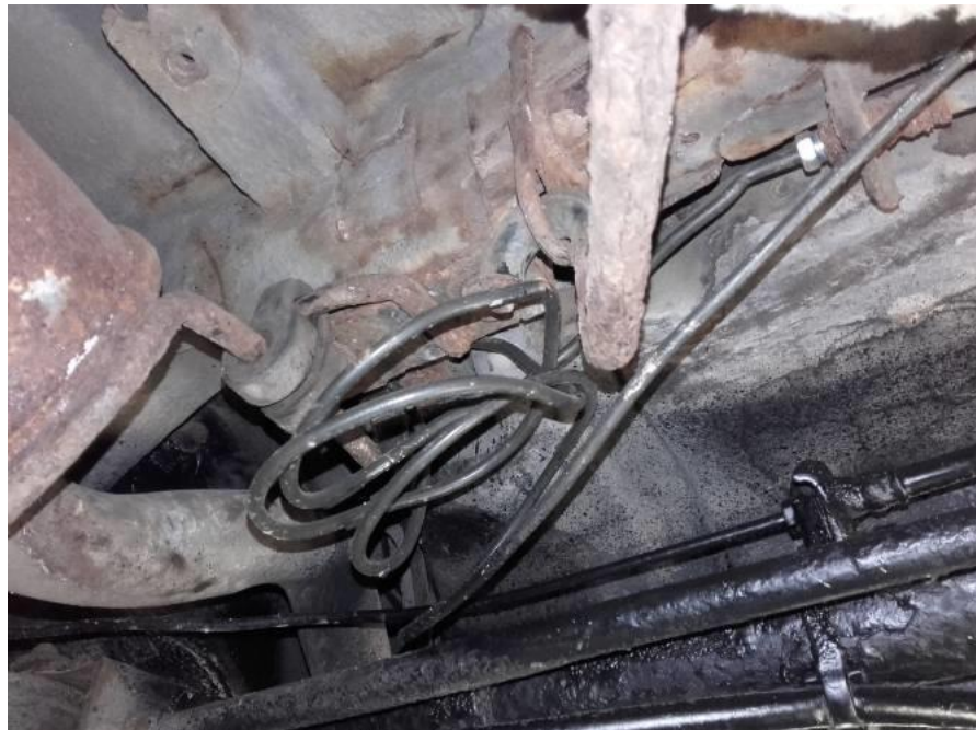
Obrázek 30 - Neodborná oprava brzdového potrubí [15]
