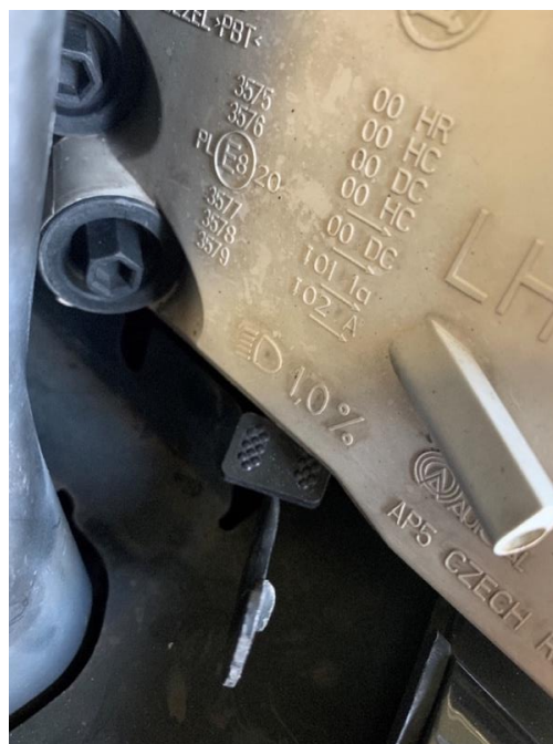
Obrázek 22 - Základní sklon světlometu [9]
