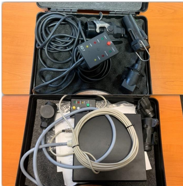
Obrázek 9 - Kontrola zapojení zásuvky 7/13 pinů [9]
