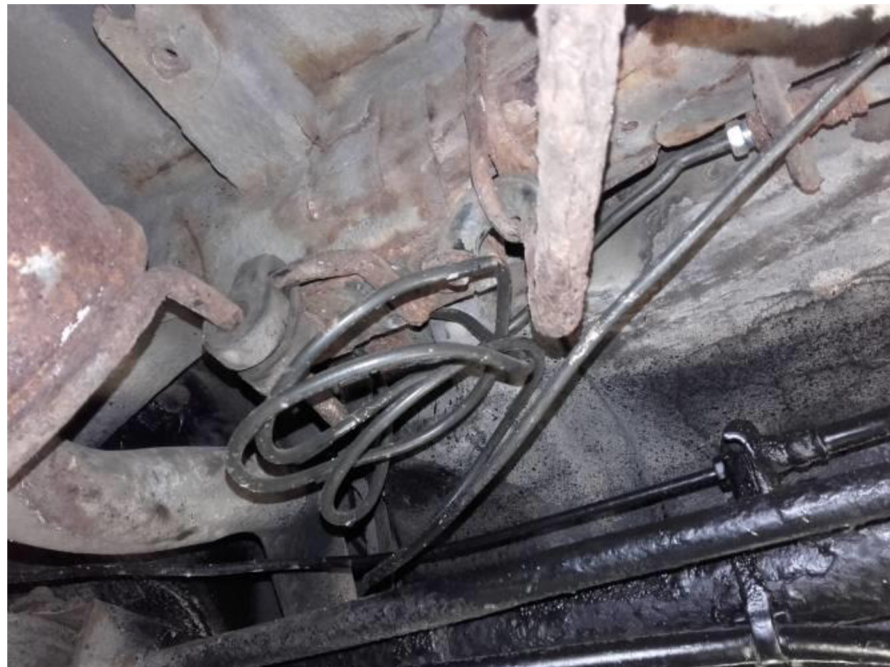
Obrázek 30 - Neodborná oprava brzdového potrubí [15]
