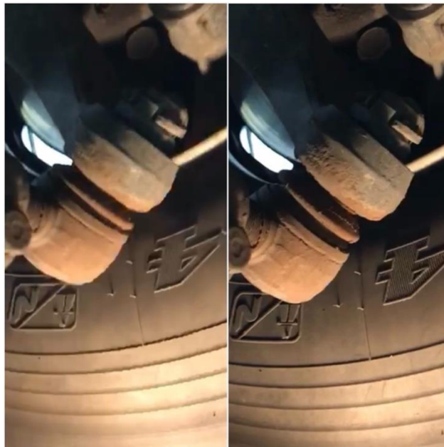
Obrázek 35 – Poškozený čep řízení [9]
