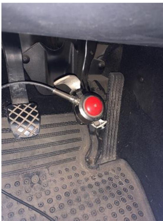
Obrázek 19 - Pedometr instalovaný ve vozidle [9]
