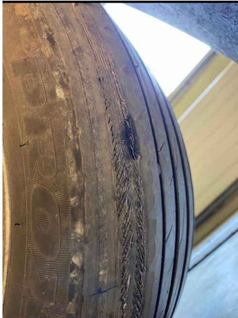
Obrázek 36 - Poškození pneumatiky (Nadměrné opotřebení)[9]
