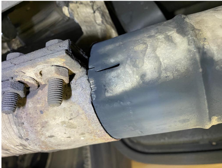
Obrázek 41 - Netěsnost výfukového potrubí [9]
