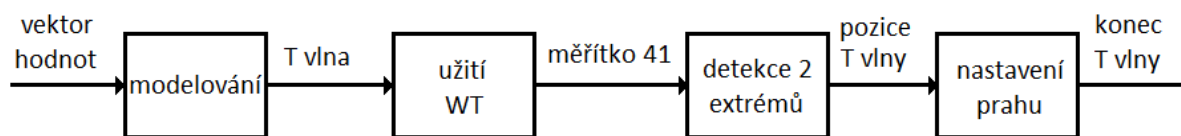
Obr. 9 Blokové schéma detekce z namodelovaných T vln
