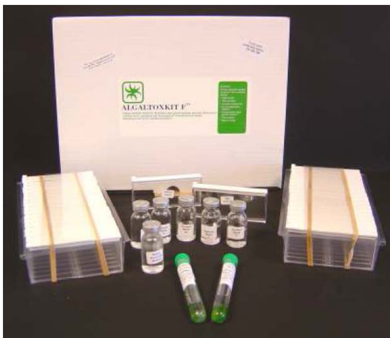
Obr. č. 4: Souprava pro řasový test v kyvetách[11]
