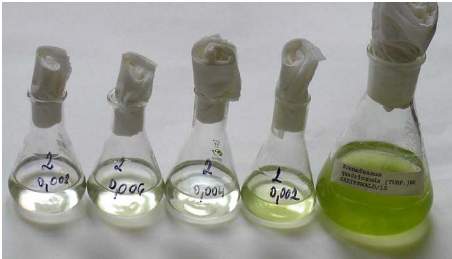
Obr. č. 8: Jednotlivé testované koncentrace zkoušené látky v Erlenmayerových baňkách s chlorokokální řasou Scenedesmus quadricauda . Kultura řasy v zásobní baňce.[6]
