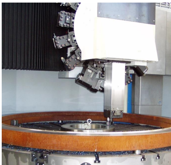
Obr. 40) Patentované hviezdicové usporiadanie zásobníka nástrojov [1]
