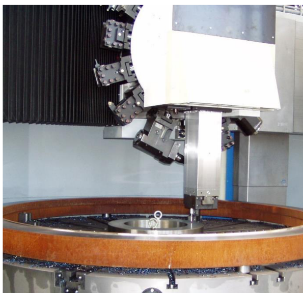
Obr. 40) Patentované hviezdicové usporiadanie zásobníka nástrojov [1]
