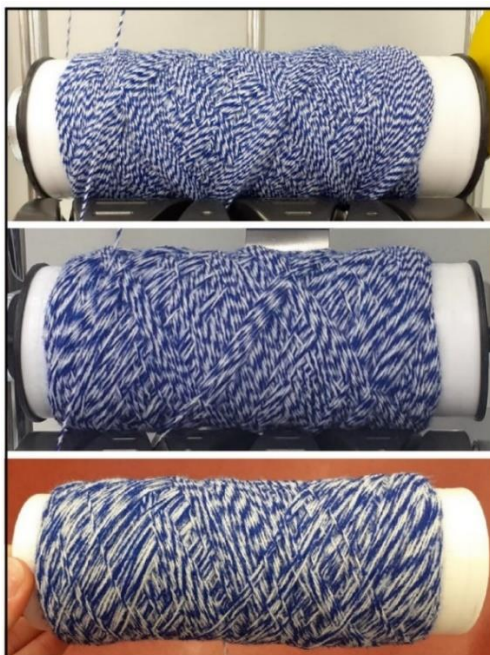
Obr. 14: Ukázky různých typů vzorování návinu na cívce [25]
