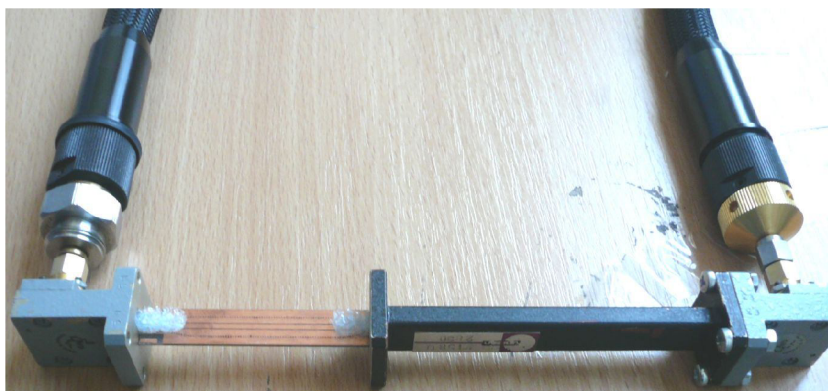
Obr. 61: Analýza podélného přechodu vedení z WR42 na GCPW ( finline ).
