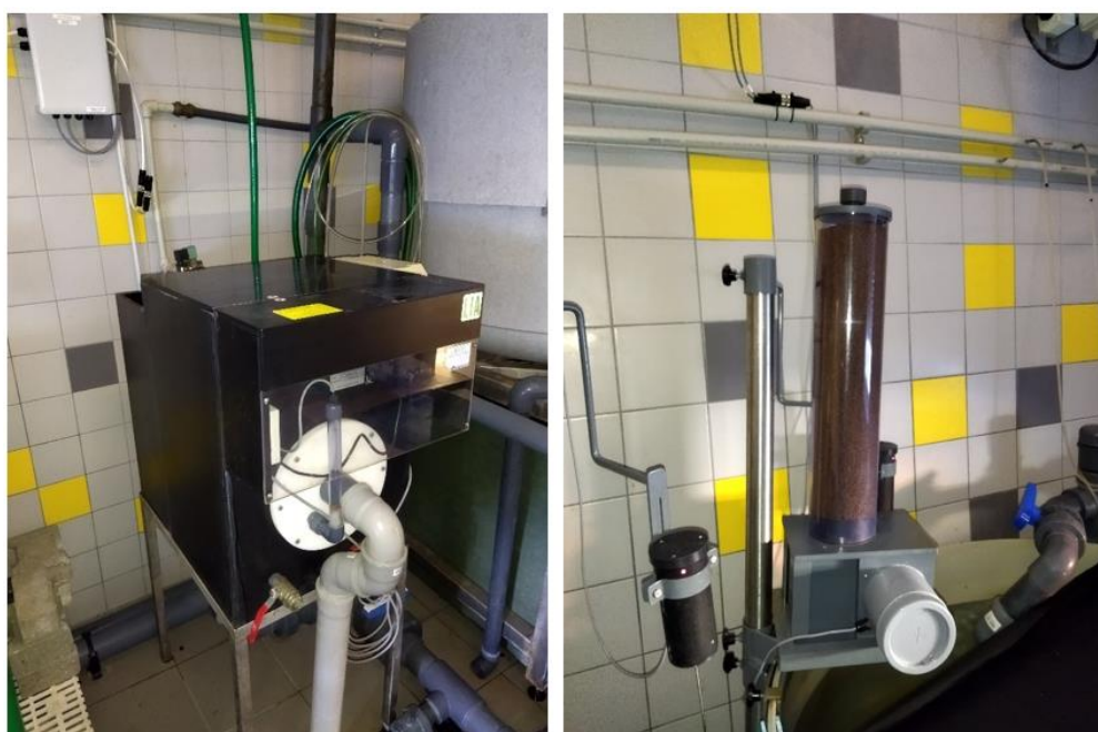
Obrázek č. 15 a 16: Vlevo: mechanický filtr BaseDrum (foto: V. Kučera), vpravo: automatické krmítko Imetronic (foto: V. Kučera)
