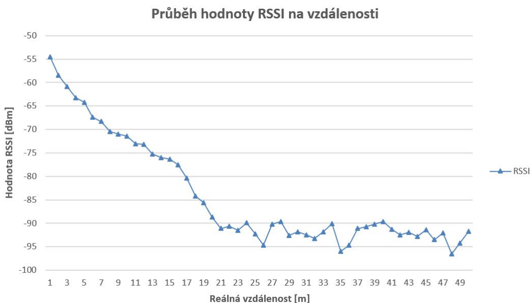
Obrázek 6: Průběh hodnoty RSSI ve volném prostoru
