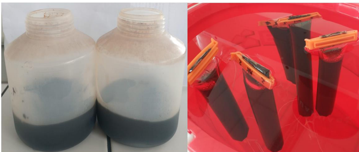
Obrázek 19: Vzorky vysrážených HK (vlevo) a dialýza proti deionizované vodě (vpravo)
