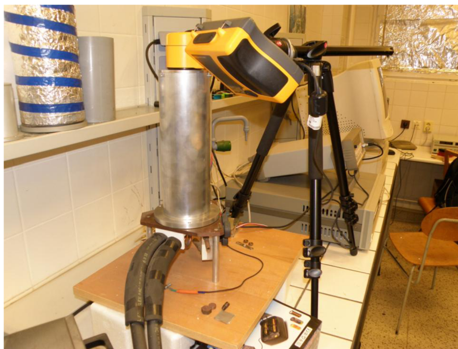
Obr. 20 Měření pomocí termokamery.
